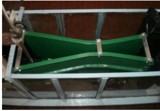
Figura 3 – Foto da Calha Parshall calibrada
