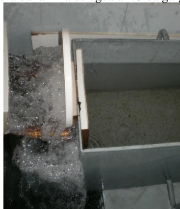
Figura 6 – Foto da leitura da lâmina de água a 2/3 da garganta, na Calha Parshall
